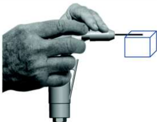
Рисунок 30 – Рабочая поза оператора при работе двумя руками с угловым напильником (полировальной машиной) с возвратно-поступательным ходом и жестким зажимом вставного инструмента
