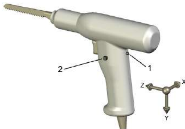
Рисунок 17 – Точки и направления измерений для ножовочной пилы с пистолетной рукояткой (Amd.1:2015, Amd.2:2019)
