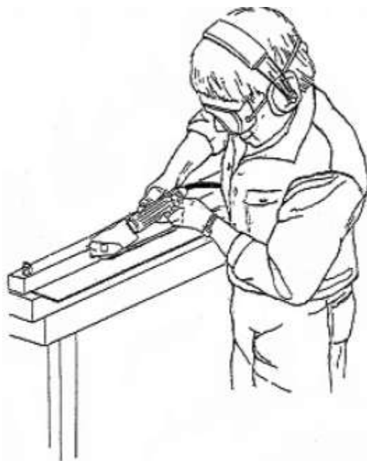
Рисунок 27 – Рабочая поза оператора, работающего с дисковой пилой
