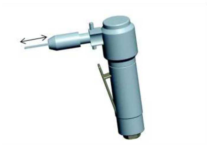
Рисунок 11 – Угловой двуручный напильник (полировальная машина) с возвратно-поступательным ходом и жестким зажимом вставного инструмента
